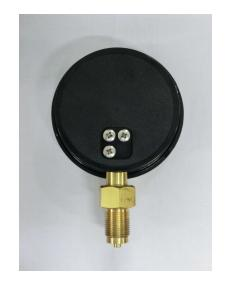
ユニオン(自在)ねじ最大の利点は、圧力計の表示(指示)部を最適な方向に 向けて固定できる点にあります。
